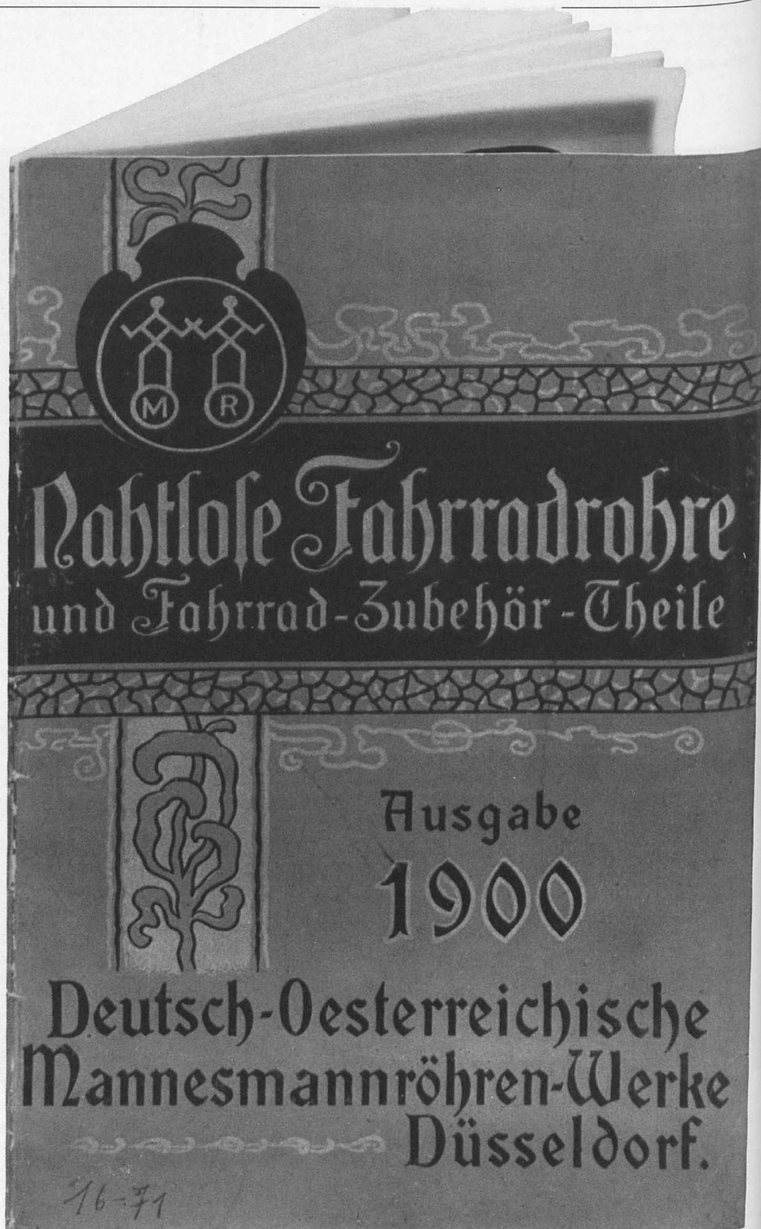
**Die älteste uns überlieferte Fahrradrohr-Preisliste von Mannesmann bot im Jahre 1900 30-mm-Rohre mit 0,8 oder 1 mm Wandstärke für 2 Mark je Meter an. Ein derartiges Rohr wog 710 Gramm.**
