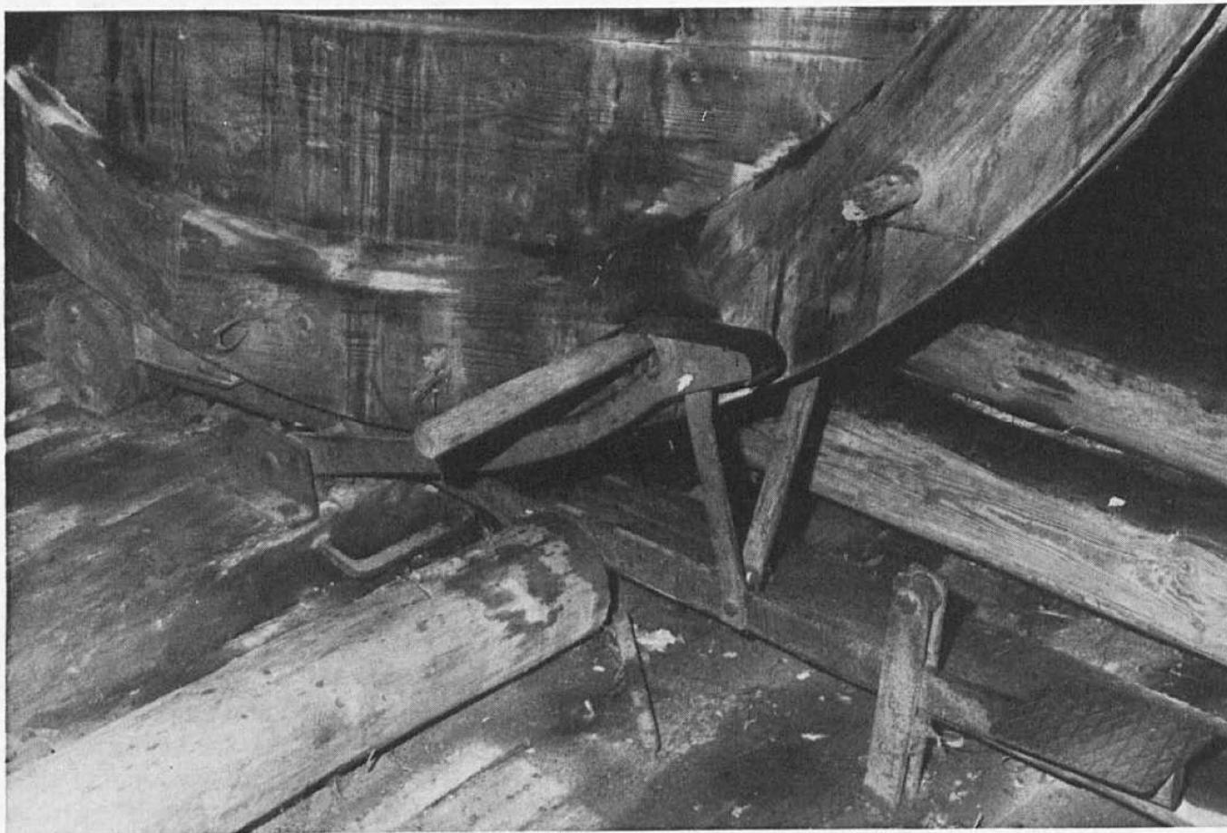
Abb. 5: Die eiserne Rücklaufsperr- und Bremsmechanik. Im Sprossen-Drehkreis die Sperrhaken, unten der Fußhebel mit (links) Bremsbacke und Gegengewicht
