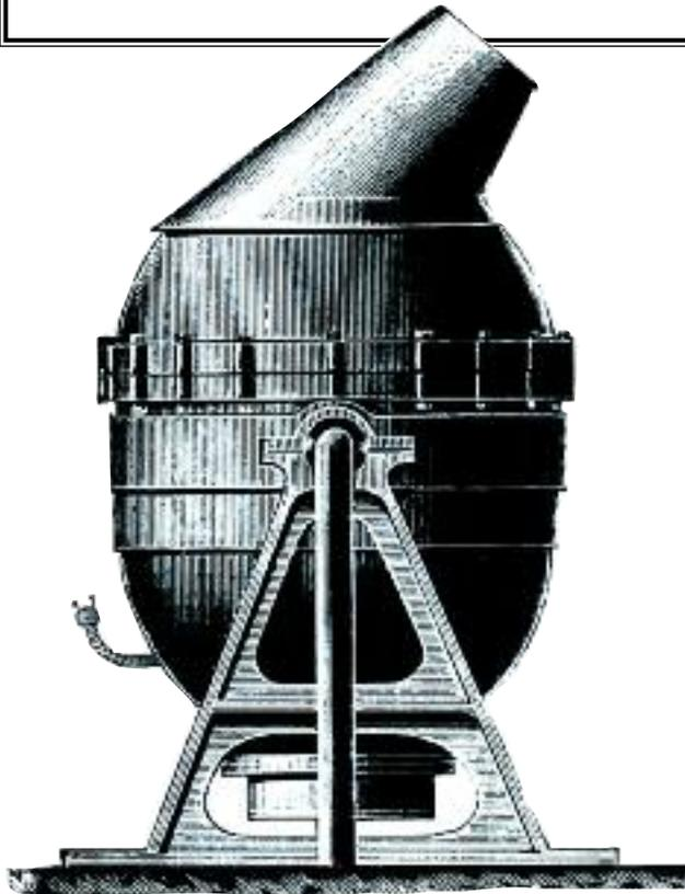
**-13-** „BESSEMER-BIRNE“: So nannte man auch dieses riesige Gefäß aus Eisen, das zum „Windfrischen“ gebraucht wird. An der Seite kannst du sehen, was darin geschieht: Roheisen aus dem Hochofen wird geschmolzen bei ..... °C. Warum denn das, nochmal schmelzen??
