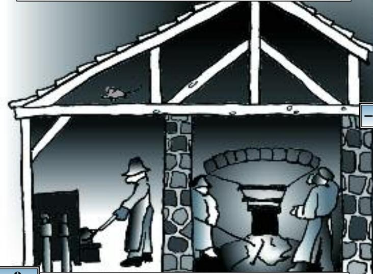
**-10-** In dieser Nische kannst du auch in den Hochofen hineinschauen. Eisenerz, Zuschläge und Holzkohle sind schichtweise eingefüllt. Die Holzkohle verbrennt und lässt das Eisenerz schmelzen. Wie heiß ist das geschmolzene Eisen?
