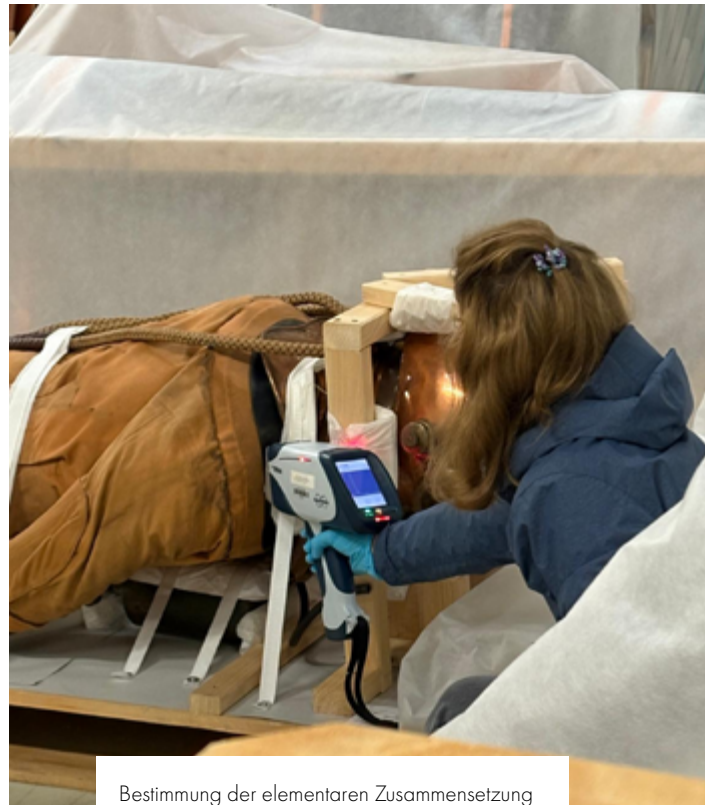
Bestimmung der elementaren Zusammensetzung des Elastomers eines Tauchanzugs aus dem Jahr 1900 (Inv. Nr. 68247).
