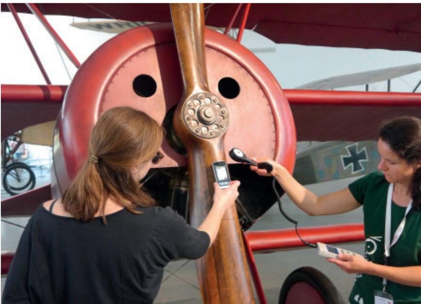
Messung von sichtbarem Licht und UV-Strahlung am Propeller der Fokker Dr I in der Alte-Lufffahrt-Halle.
