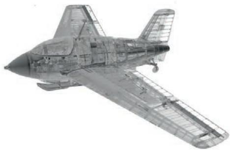
Die zusammengesetzten CT-Scans von Rumpf und Flügel lassen ein vollständiges 3D-Abbild der Me 163 entstehen.
