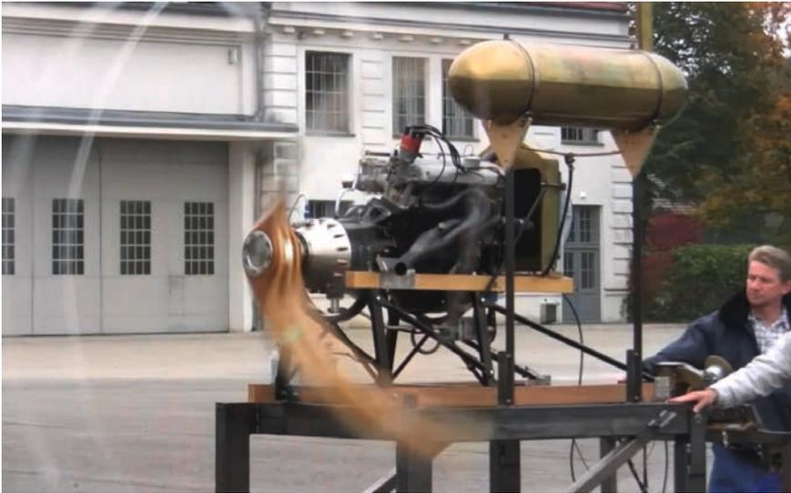
Der erste Prüflauf des kompletten Otto-Antriebes mit Sondergetriebe und Propeller fand am 6. Oktober statt.
