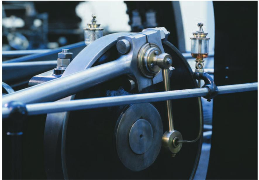
werden: Sie liegt in den unterschiedlichen thermodynamischen Eigenschaften von Wasserdampf und Luft. Beim Dampfbetrieb werden nicht nur Druck- und Temperaturdifferenz in Arbeit umgewandelt, sondern es fällt auch Kondensationswärme an. Diese erhöht die Kraft des Kolbens im Niederdruckzylinder auf die Kurbelwelle, die den Hochdruck- und den Niederdruckteil verbindet. Die Maschine wird daher jetzt mit Luft unter bedeutend geringerem Druck betrieben.
