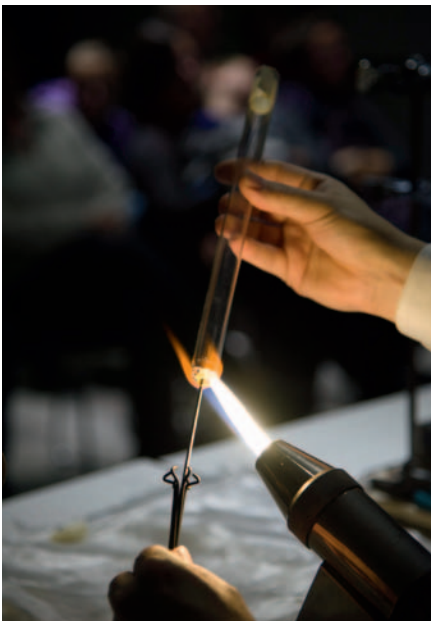
Das Glasrohr wird über den Metallstab geschoben und verbindet sich mit der dort vorher aufgeschmolzenen Glashülse.
