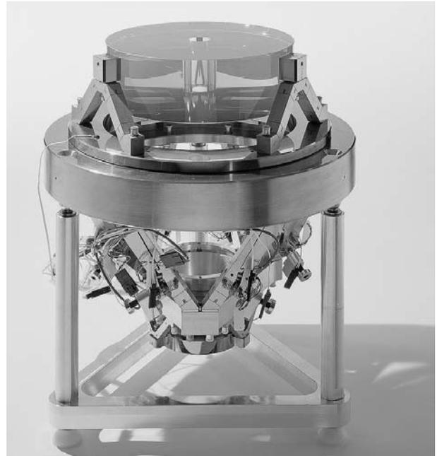
Das »Micro Exposure Tool« der Carl Zeiss AG. Die spezielle Belichtungsoptik für »Extremes Ultraviolett-Licht« (EUV mit 13 nm Wellenlänge) arbeitet mit extrem glatten Spiegeln statt mit Linsen.
