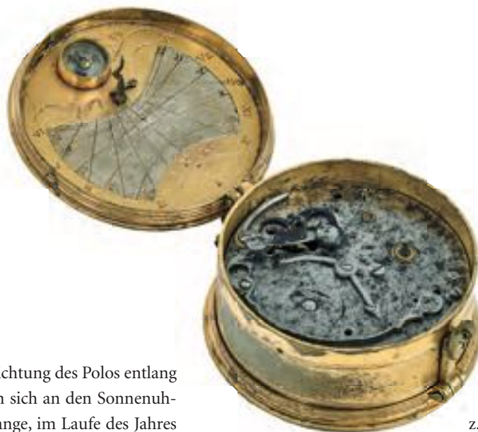
Eine Taschenräderuhr mit integrierter Sonnenuhr und kleinem Kompass, 1565 vielleicht in Süddeutschland hergestellt (Durchmesser: 5,2 cm).
