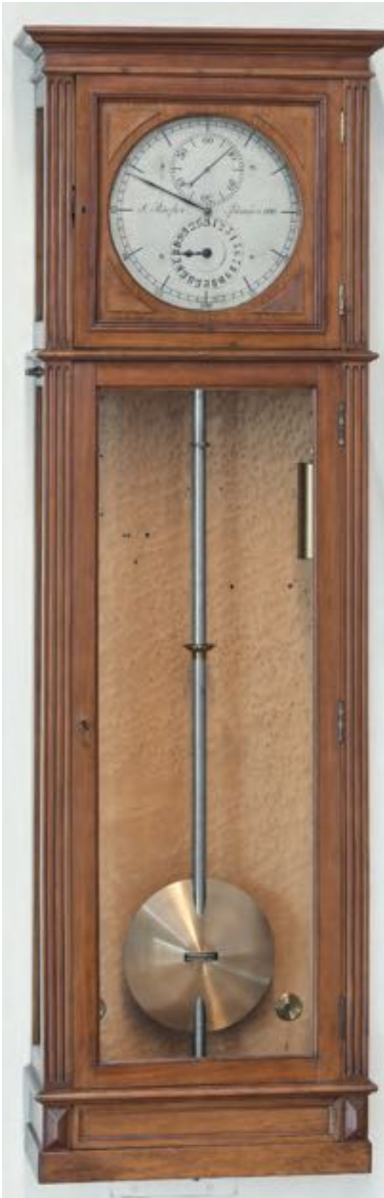
Präzisionspendeluhr Riefler von 1890 aus der Münchner Universitätssternwarte.
