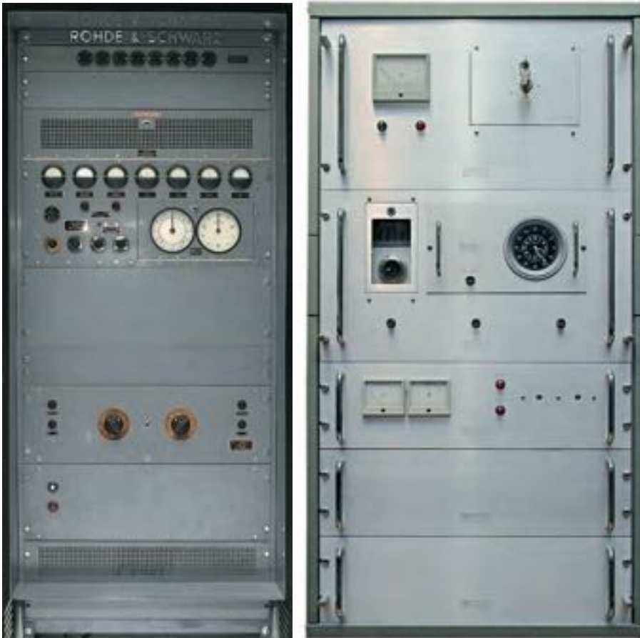
Links: Quarzuhr mit Elektronenröhren »CF Qu« von Rohde & Schwarz. Rechts: Cäsiumatomuhr »Oscillatom B 5000-20« von Oscilloquartz. Beide Uhren können in der Ausstellung Zeitmessung im Deutschen Museum besichtigt werden.
