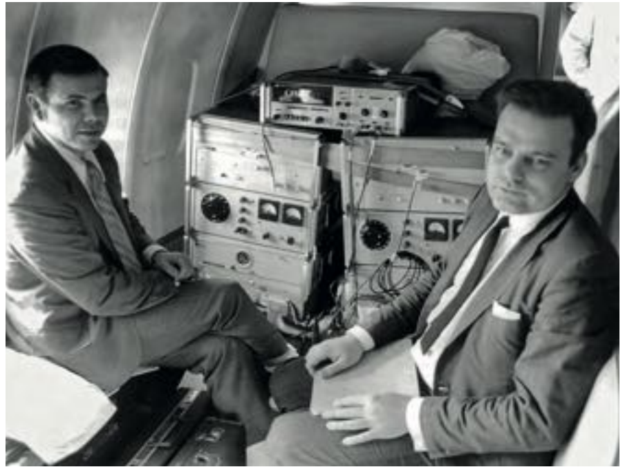
Mit hochpräzisen Atomuhren an Bord starteten im Oktober 1971 die Physiker Joseph C. Hafele (l.) und Richard Keating (r.) zu einem Rund-um-die-Welt-Flug.
