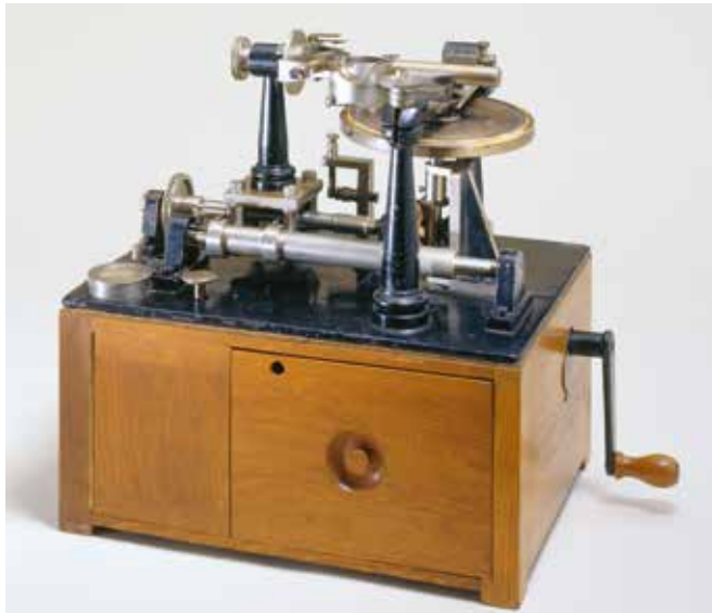
Bild links: Der Archiv-Phonograph (Typ I) des Wiener Phonogramm-Archivs nutzte Edison-Schall Dosen für die Aufnahme und Wiedergabe von Platten und wog mit Ausrüstung über 100 Kilogramm.
