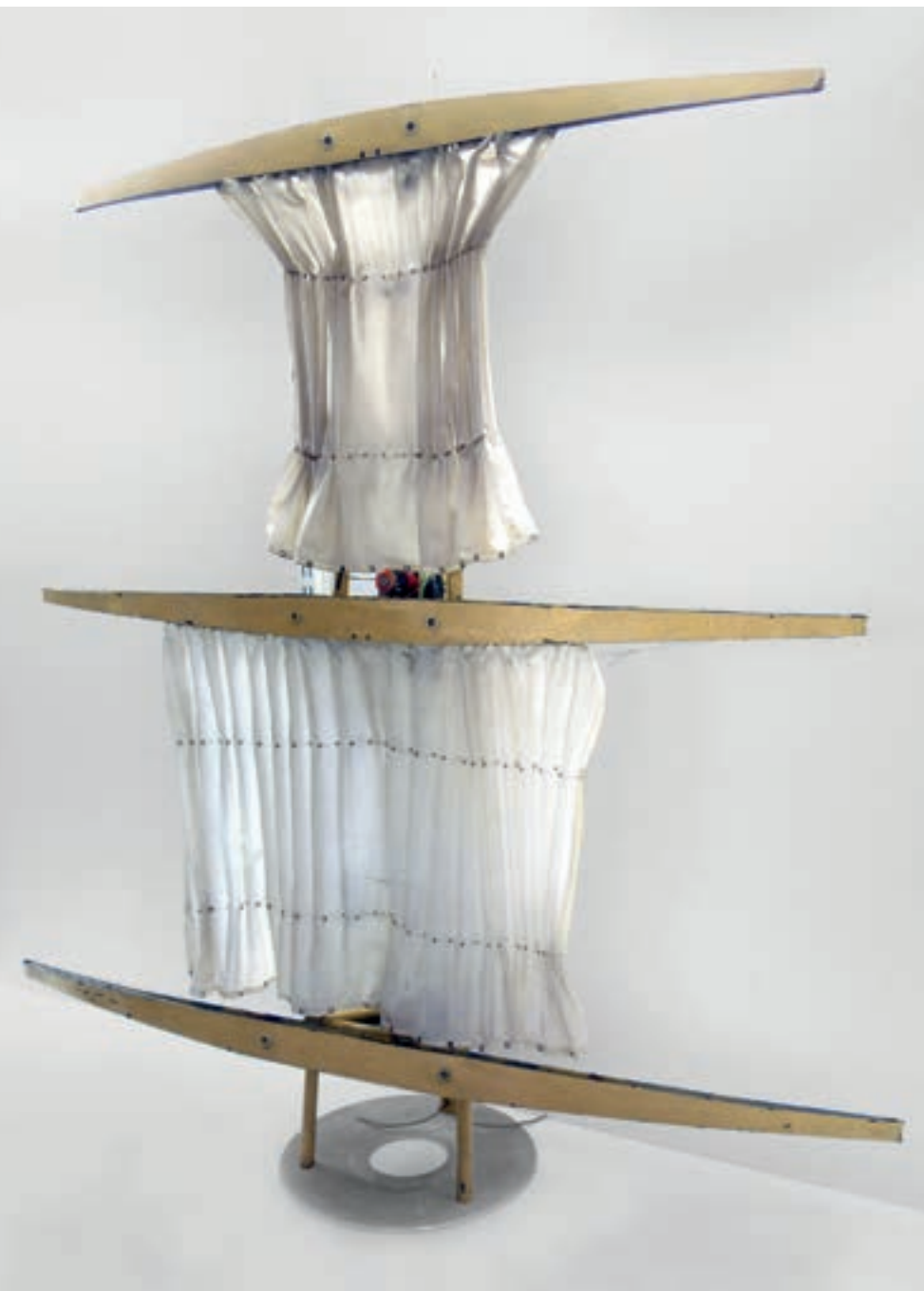
Das mechanische Entwurfsmodell des Dynariggs, ein Relikt der Versuche in Hamburg, ca. 1962. Die Segel werden zum Mast gerefft.
