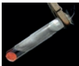
Rotes Quecksilberoxid wandelt sich beim Erhitzen in metallisches Quecksilber um, erkennbar an den grauen Tröpfchen am Reagenzglas. Dabei entsteht Sauerstoffgas.
