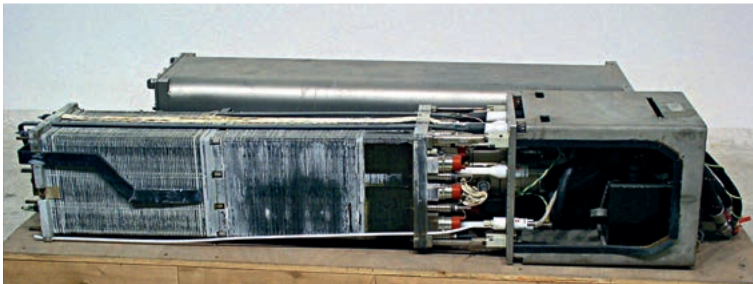
Die Brennstoffzelle mit einer Leistung von sieben Kilowatt, wurde 1987 auf dem Tauchboot U1 (IV) gefahren. Sie basiert auf der Umkehrung der Elektrolyse des Wassers und erzeugt Strom und Wasser.
