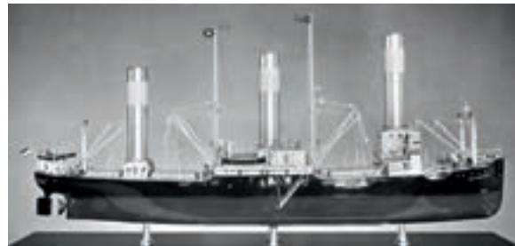
Rotorschiff Barbara (1926). Das Modell wurde 1927 von der Reichsmarine gestiftet. Beim Rotorschiff werden die Zylinder und die umgebende Luft durch Motoren in Rotation versetzt. Im Wind wird die Luftströmung auf der einen Seite schneller, auf der anderen Seite langsamer, wie bei einem Flugzeugflügel. Der entstehende Druckunterschied ist etwa zehnmals größer als bei einem Segel mit der gleichen Fläche.
