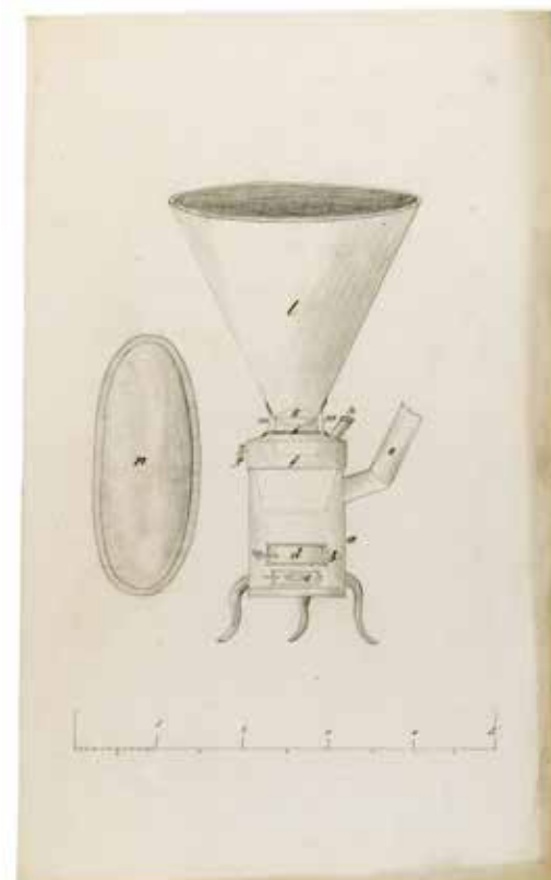
Bayerischer Erfindungsreichtum: Desinfektionsapparat zur Reinigung von Bettfedern und Rosshaaren, 1855; Polytechnischer Verein in Bayern, Vorl. Nr. 0268.
