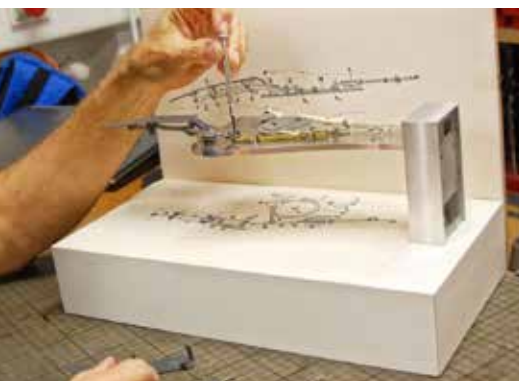
Funktionsmodell einer künstlichen Hand nach der Zeichnung und Beschreibung des Mechanikers Will aus dem Jahr 1916.
