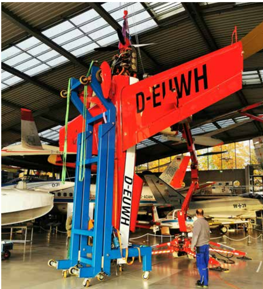
Die Vorrichtung zum Aufrichten des Kunstflugzeugs Extra 300 wird in der Ausstellungshalle ausprobiert.
