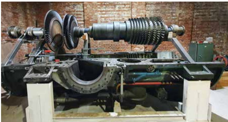
Die zweiwellige Gasturbine Sulzer NSR-63 bei der Restaurierung.
